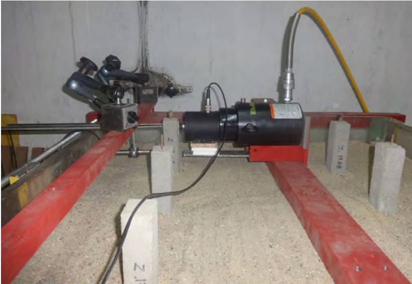
Rys. 4. Układ obciążający (siłownik i siłomierz) oraz czujniki do pomiaru przemieszczeń pala
