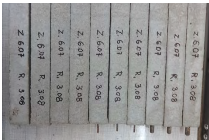
Rys. 1. Pale przygotowane do badań modelowych
