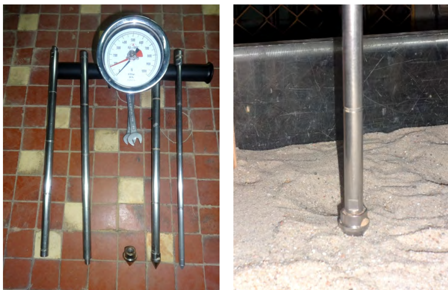
Rys. 3. Sonda statyczna HANSON 5
