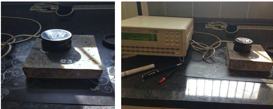
Rys. 1. Stanowisko do badań parametrów cieplnych z wykorzystaniem aparatu Applied Precision ISOMET 2104
