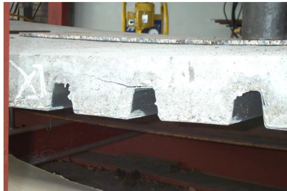
Rys. 8. Pierwsza rysa w płycie badanego modelu [5]
