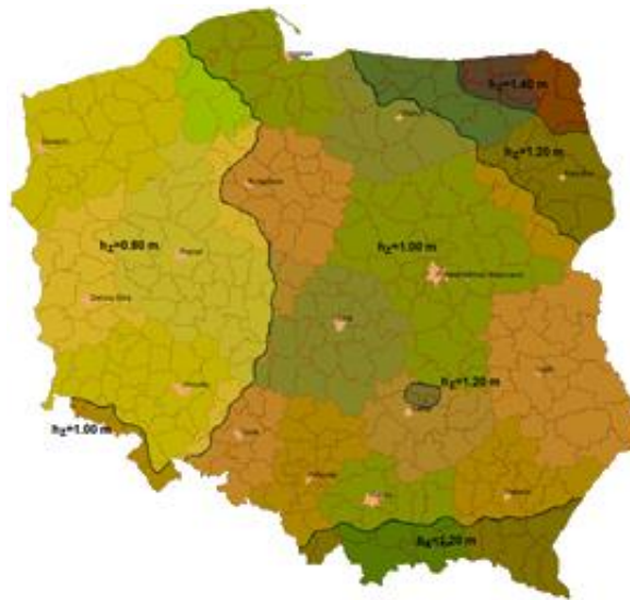
Rys. 1. Głębokość przemarzania gruntu wg PN-81/B-03020 [1]
