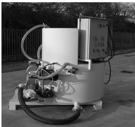
Rys. 1. Pianogenerator o wydajności do 10\text{ m}^3/\text{h} [1]
