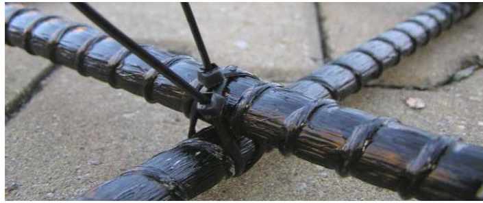
Rys. 7. Widok prętów epoksydowo-bazaltowych połączonych samozaciskową taśmą [21]
