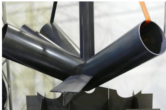
Rys. 2. Węzeł kratownicy przestrzennej przed zespawaniem, zawieszony nad stelażem do scalania (fotografia autora)
