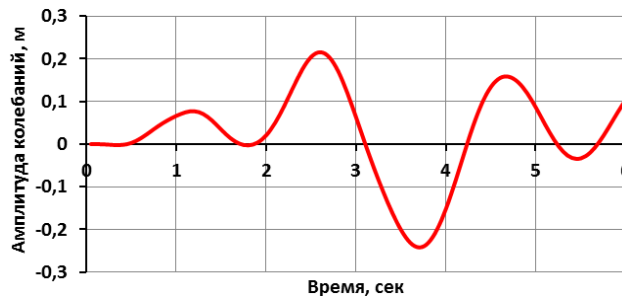
Рис. 3. Горизонтальные колебания верха 47-ми этажного здания
