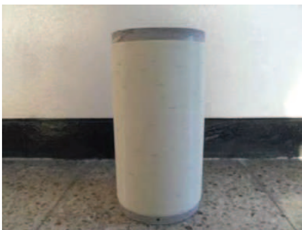
Rys. 2. Próbkki betonowe wzmacniane: a) drutem kompozytowym [13], b) tubą wykonaną z materiału FRP [14]
