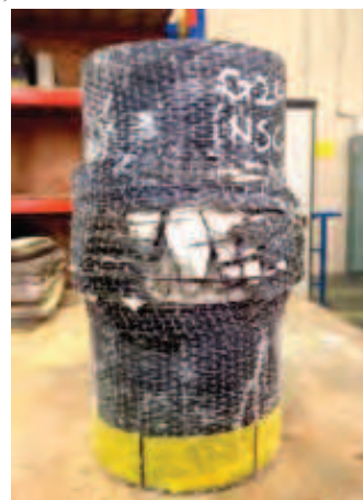
Rys. 2. Próbkki betonowe wzmacniane: a) drutem kompozytowym [13], b) tubą wykonaną z materiału FRP [14]
