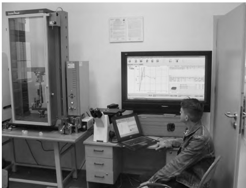
Rys. 1. Stanowisko do badań wytrzymałościowych próbek jesionu na maszynie Zwick Roell w specjalistycznym laboratorium Bielskiego Centrum Kształcenia Ustawicznego i Praktycznego
