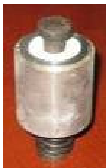
Рис. 2. Пресс-форма для электроконтактного спекания твердосплавной фильеры в сборке
