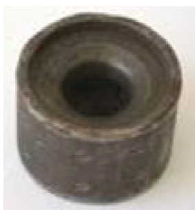
Рис. 5. Фильера для правки строительной арматуры
